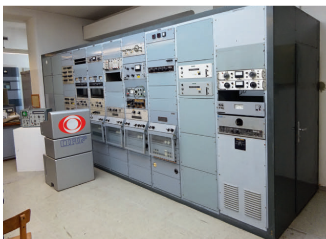
Abb. 11: Gestell zur Tonfrequenzaufbereitung mit Meßgeräteeinschüben, links ein Rednerpult mit bekanntem „ORF-Auge“
